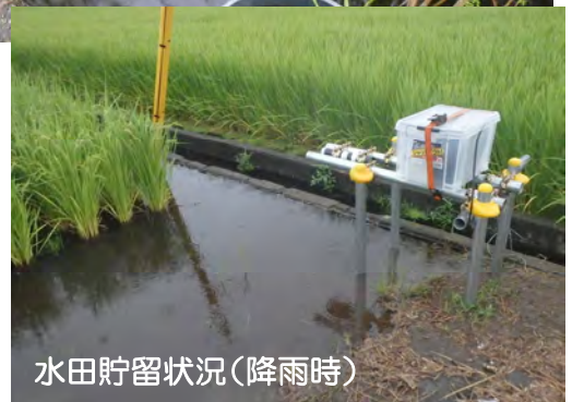
図 4-7 田んぼダムの取り組み(南アルプス市における実証実験の様子)
