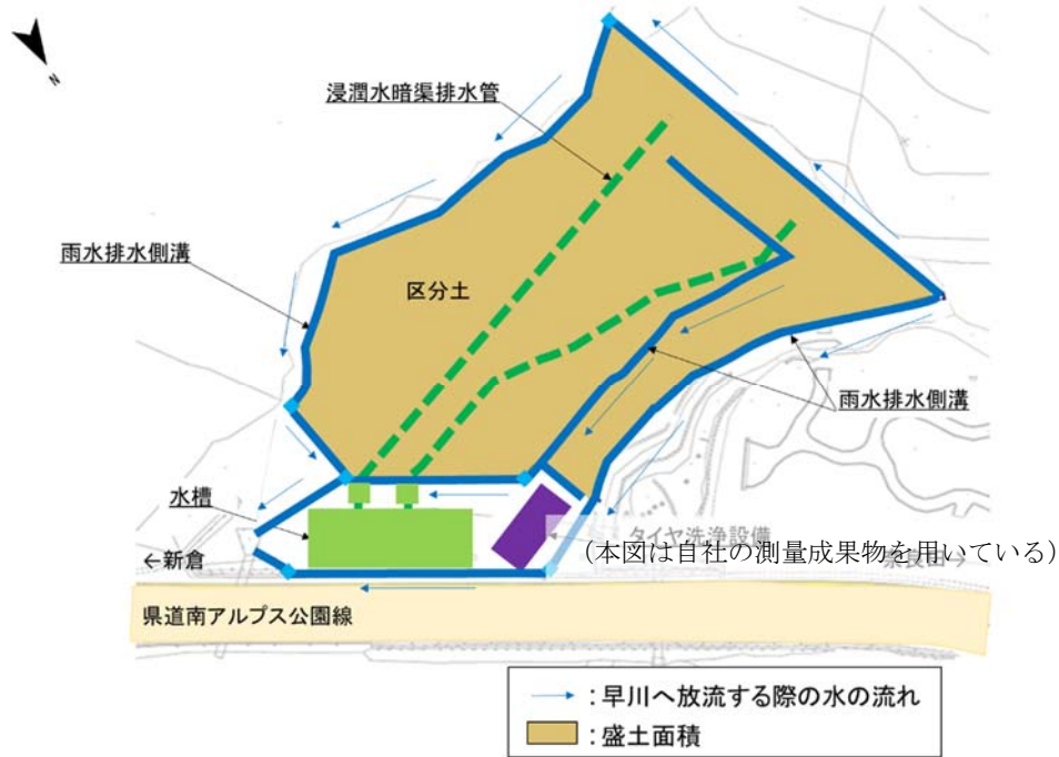
図 6-7-1(3) 変更区域及び排水設備の設置状況（湯島地区発生土仮置き場）
