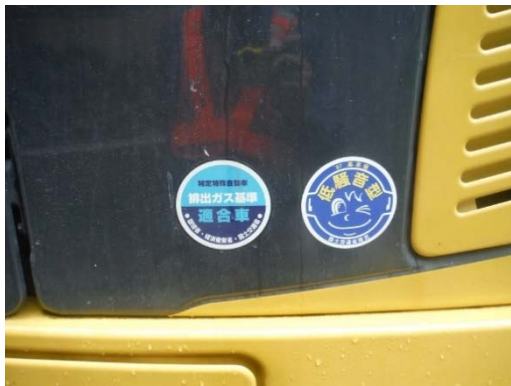
写真 6-6-1 排出ガス対策型、低騒音型 建設機械の採用
