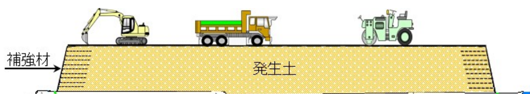
図2-4 (1) 中洲地区発生土仮置き場における主な施工手順（発生土搬入、締固め）
