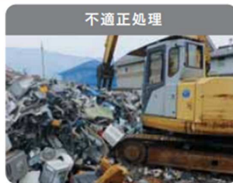
環境対策を行わずに廃家電を破壊することで、フロンガスや鉛などの有害物質が環境中に放出されます。
