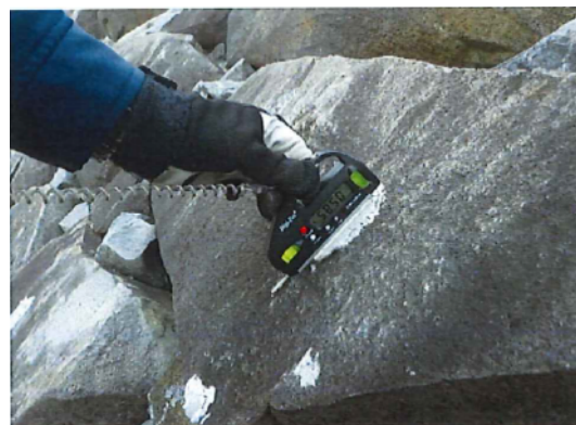
第〇図 傾斜計測定の様子
