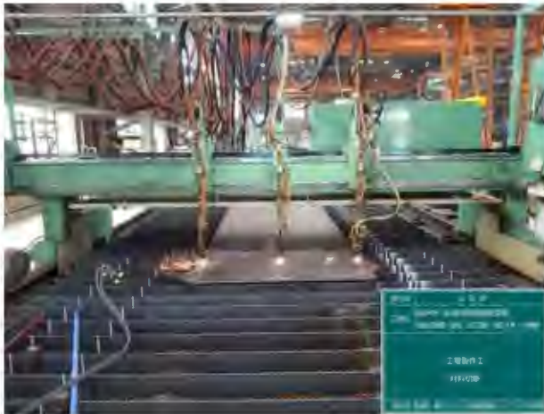
鋼材切断状況
