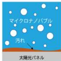
付着した汚れの間に水が浸透
