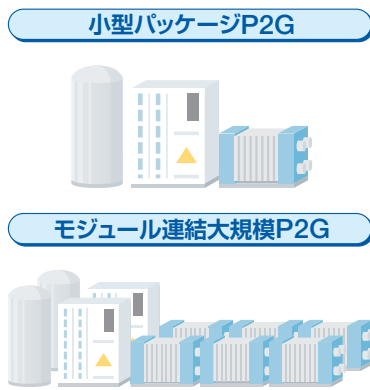
装置を連結することで、さまざまな容量のシステム構築が可能
