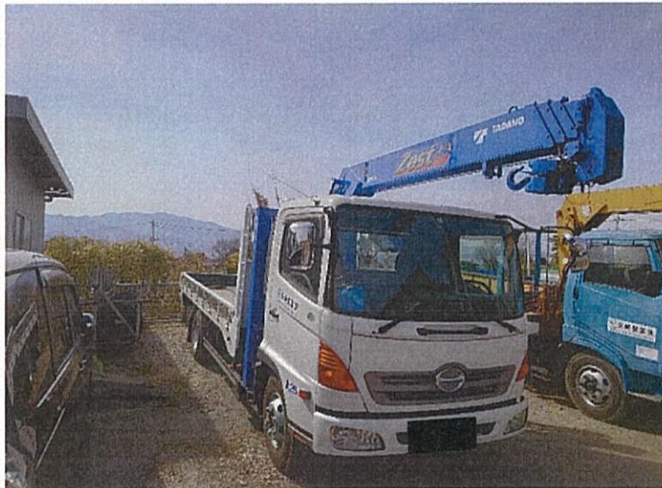
4t トラッククレーン機能付きセルフローダ
