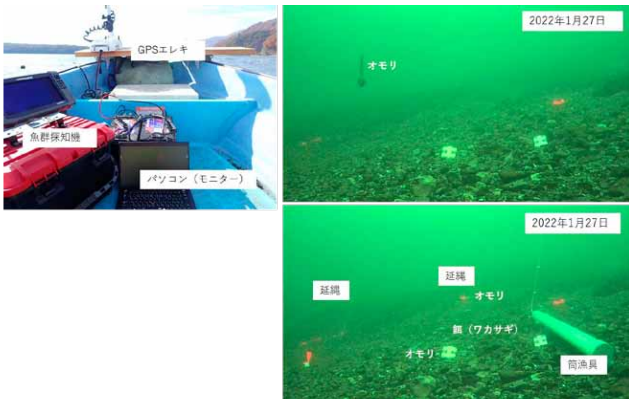
図3 漁具投入時の様子 (左:GPS エレキで定位してモニターで礫地の様子をリアルタイムに観察しながら漁具を投入, 右上:モニターを見ながら漁具を投入, 右下:投入した漁具)
