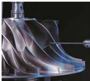
回転式スキニングプローブを使用したタービンブレードの測定
