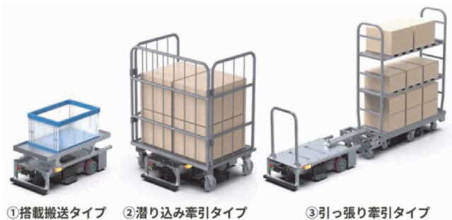
【有軌道タイプのAGVの搬送方式3種】
