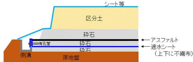
図2 補強盛土底盤部の遮水構造
