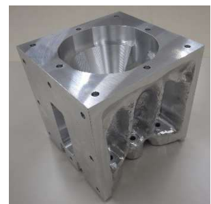
図3 加工後の治具形状
