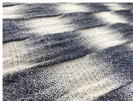
図2 強撚糸を用いた凹凸グラデーションの試織
