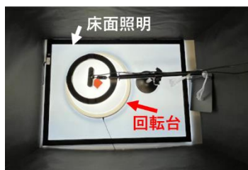
図1 暗箱内の撮影環境 (左：暗箱内全体、右：回転台付近)
