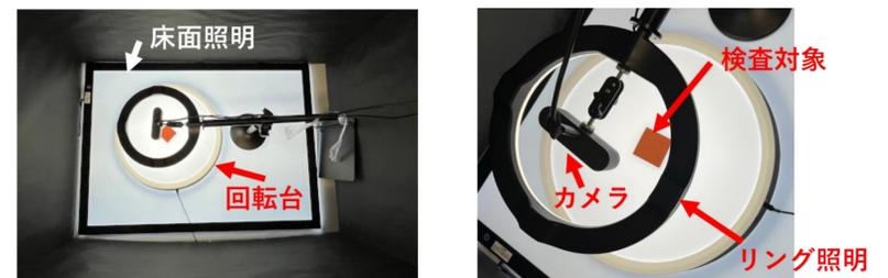
図3 撮影用暗箱内部(左)と照明設置の様子(右)
