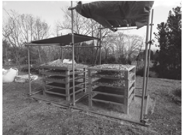
写真2 網棚による天然乾燥の様子
