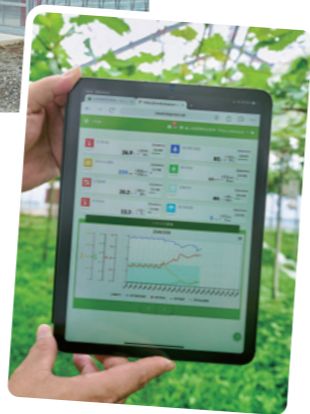
左上/白いボックスにグリーン水素が充填され、「水素暖房機」を通じてビニールハウス全体に温風が送風される。右下/タブレットには温度や湿度、土壌温度、CO 2 濃度から土壌水分量まで、栽培に必要なデータが詳細に記録されている。
