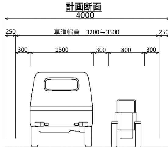
地区内の農道は道幅が狭く、農作業車両のすれ違いが困難である。また、舗装されていないことから、降雨時等に道路表面の軟弱化や轍が発生し、維持管理に多大な労力を要している。
