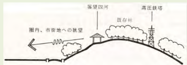
図 4.4.2 高圧鉄塔が視界に入らない位置に展望四阿を配置
