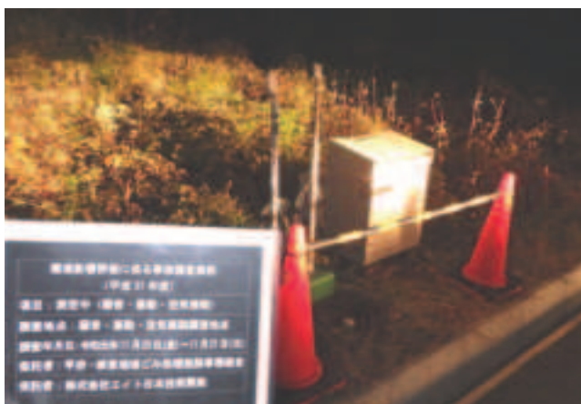
写真 5.5-2 騒音・振動・空気振動（低周波音）調査の状況
