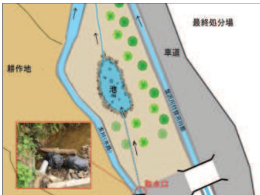
図 5.10-37 下流側ビオトープへの取水経路と当初の取水口付近の状況
