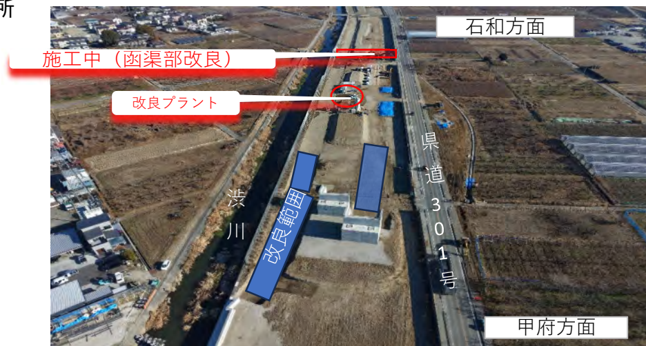
地盤改良施工状況（パワーブレンダー工法）
