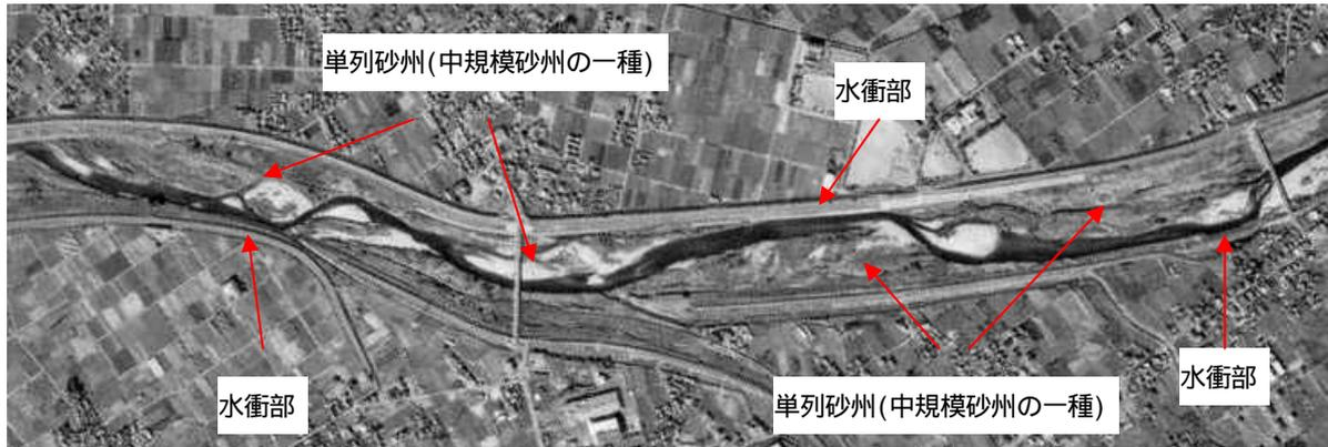
図 6.1.1 中規模砂州と水衝部
