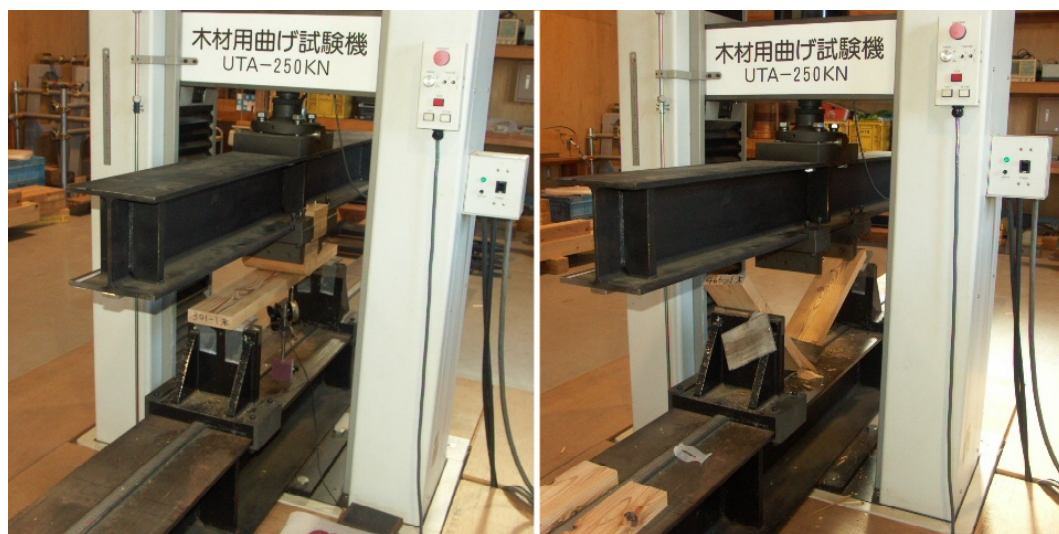
写真2 ラミナの曲げヤング係数（左）および曲げ強さ（右）の測定風景
