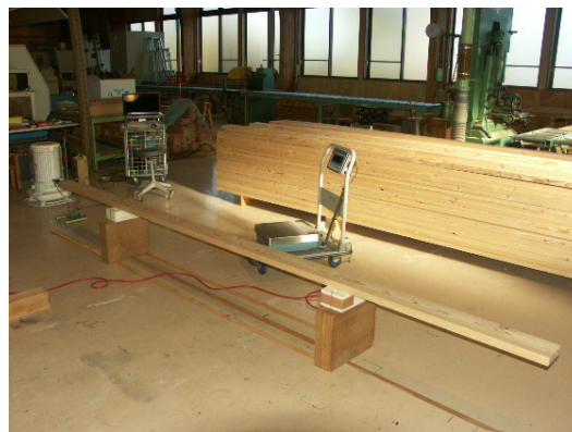
写真1 ラミナの縦振動ヤング係数の測定風景
