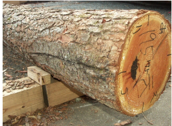
写真5 丸太材面のへび下がり
