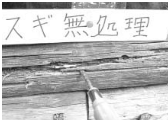
▲写真 目盛り付きドライバーを使った土留めの測定
