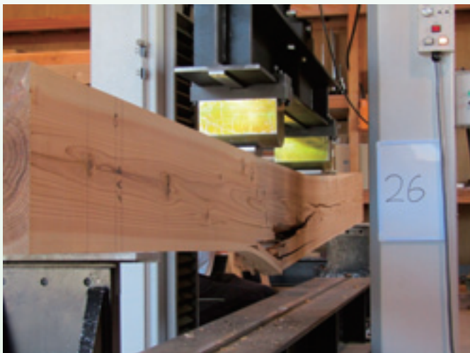
スギ平角材の曲げ強度試験
