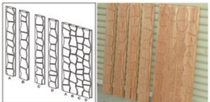
図・写真4 接合部の形状異なる試作品
