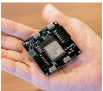
5センチ四方の手のひらサイズのコンピュータ「スクーミーボード」
