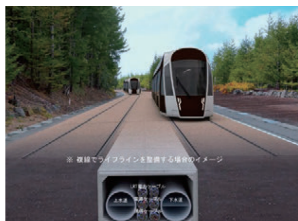
路面電車の軌道の下にケーブルを敷くなどしてインフラを整備する
