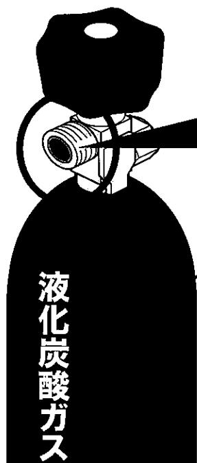
事故の背景には、酸素ボンベと同じ接続口（口径、ネジ部が同じ）の**工業用液化炭酸ガスボンベ**を院内で採用していたことが確認されています。
