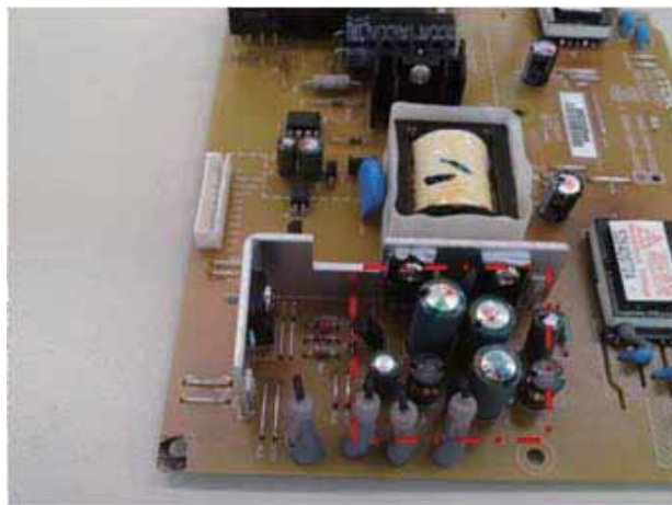
図 4 液晶ディスプレイ用ドライバー回路基板
