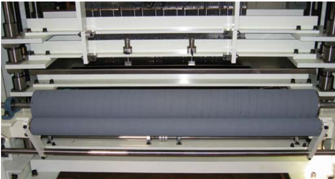
図7 新たな試作装置の布送り駆動ロール部
