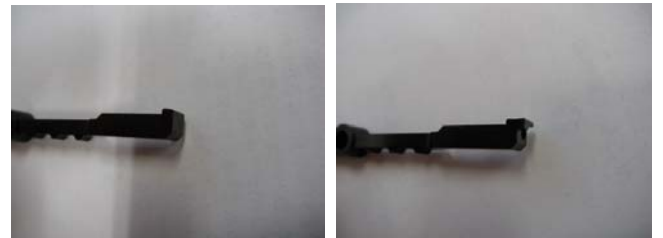
旧ストッパー 新ストッパー 図 1 ニードルカセットのストッパー形状比較
