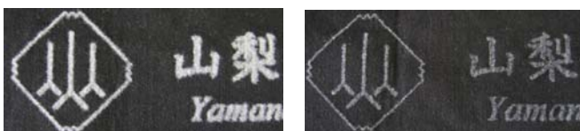
ニードル突き出し量 15mm ニードル突き出し量 5mm
