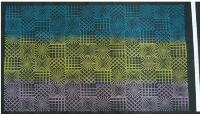
図 14 各種直線・円の加工結果
