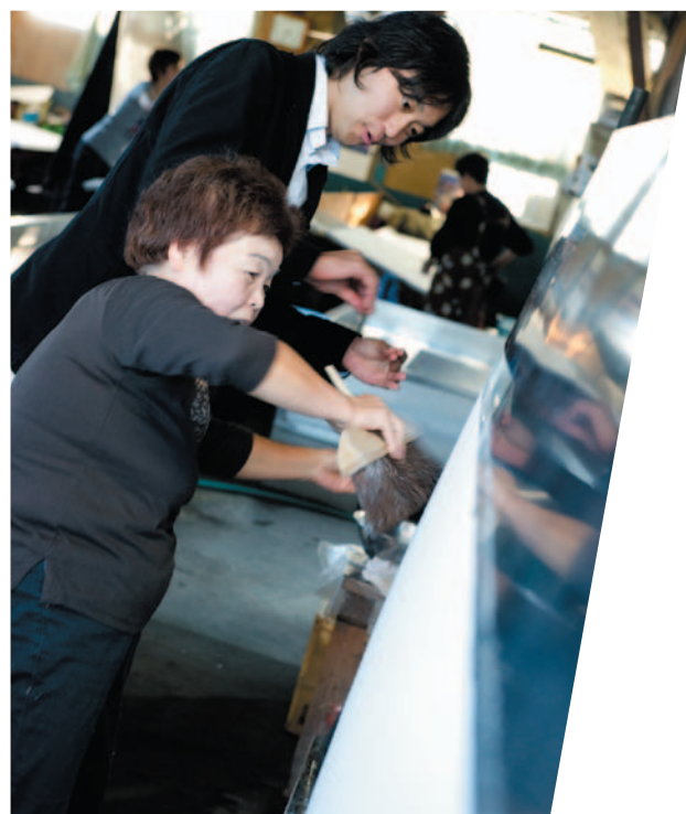
大きなアイロンのような鉄板に1枚ずつ刷毛で伸ばし乾かします。高度な紙干しを軽々とこなす職人技に双雲さんもびっくり
