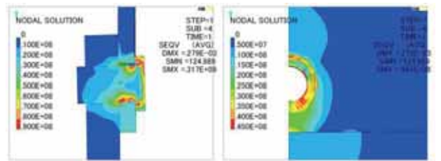
⑤ 接触部を全て接触条件とし軸力を考慮した条件
