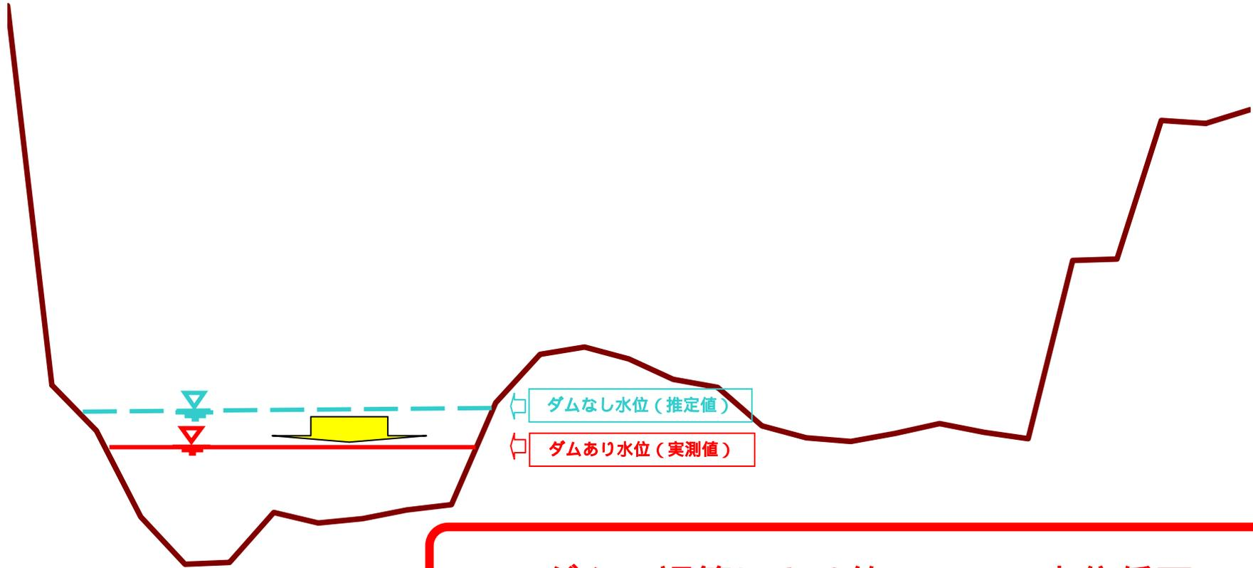
ダムの調節により約0.49mの水位低下
