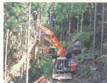
列状間伐作業地におけるスイングヤードによる集材とプロセッサによる造材
