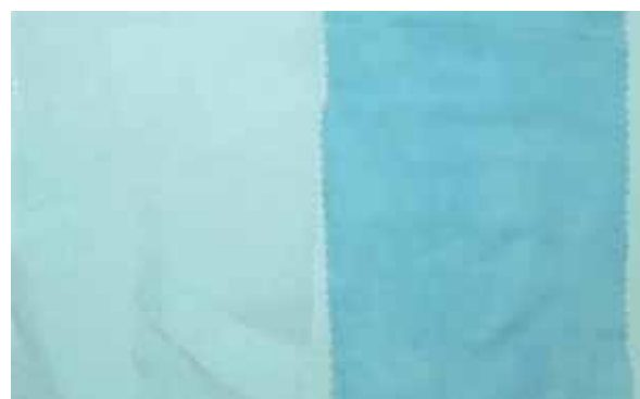
図2 セリシン付与ポリエステル生地の染色試験 A：未処理，B：セリシン定着処理
