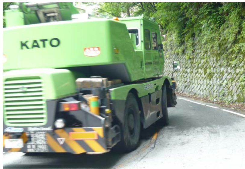
②ヘアピン部（大型車が反対車線にはみ出し危険）
