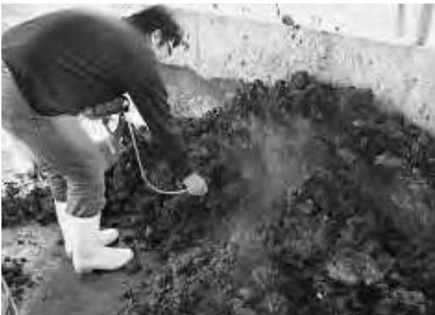
写真-7 臭気のサンプリング
