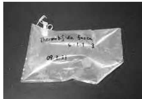
写真-8 テドラバック法
