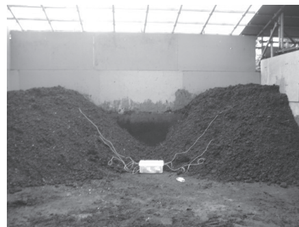
図2 堆肥の堆積と温度計設置(3点で測定)
