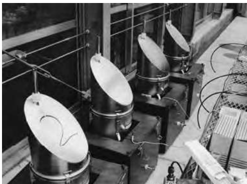
写真-4 小型堆肥化実験装置
