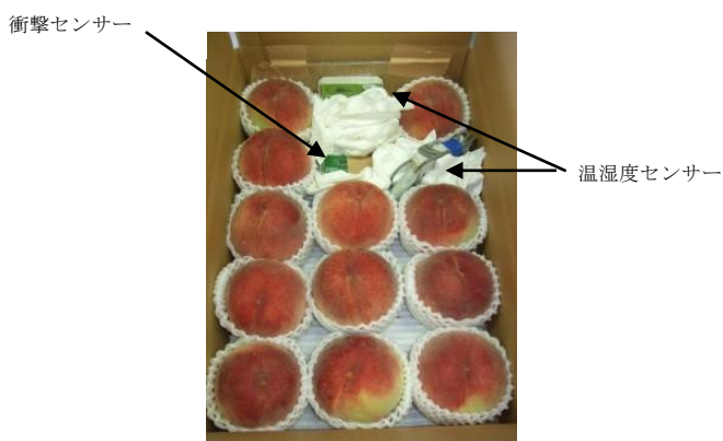
写真2 センサタグの設置
