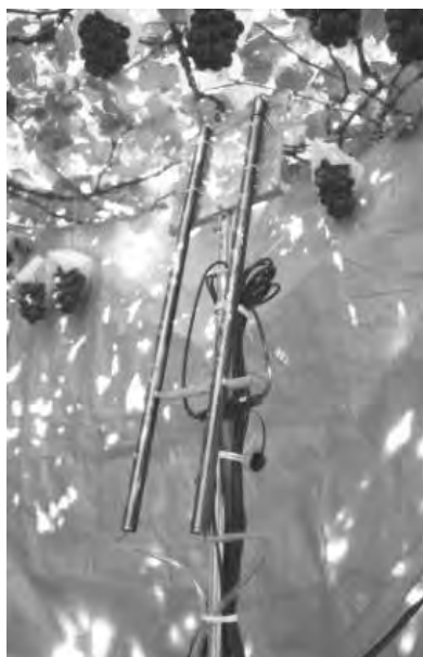
図3 ハウス内に設置したサーチライト型光源
