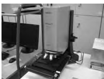
図10 コンフォーカル顕微鏡
