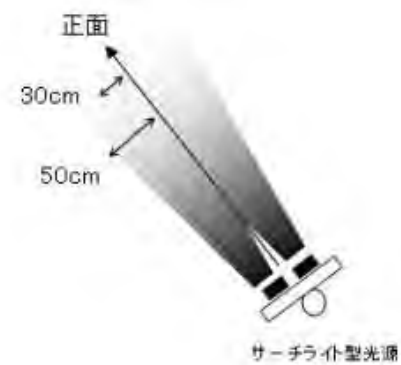
図6 サーチライト型光源の光子束密度の測定部位
