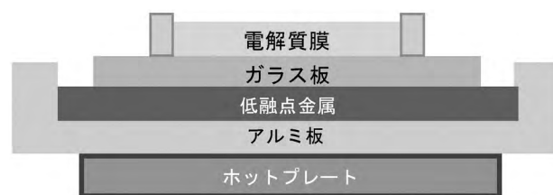
図10 成膜装置概要 (断面図)
