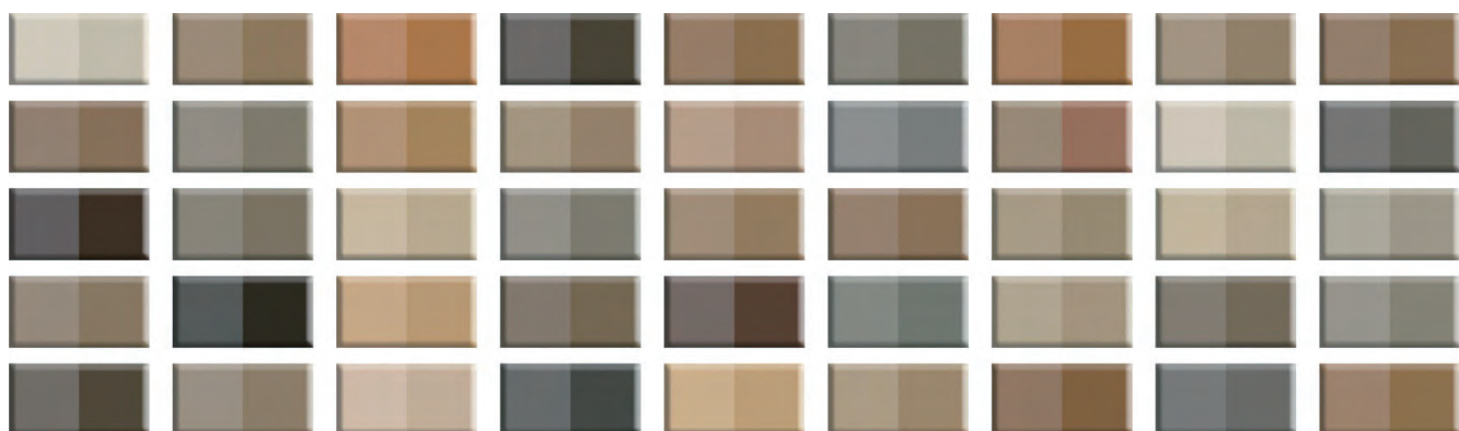
図7 Lab値に基づき色再現したカラーサンプル (左 : SCI値 右 : SCE値)
