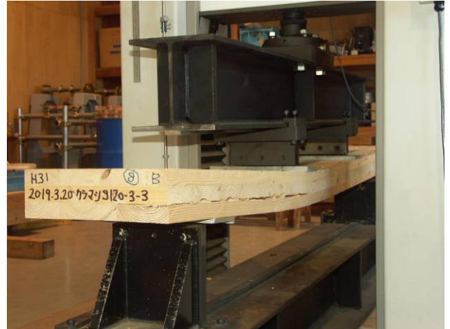
写真3 カラマツCLTの破壊状況
