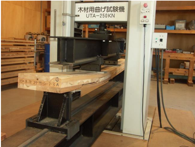
写真2 スギCLTの破壊状況
