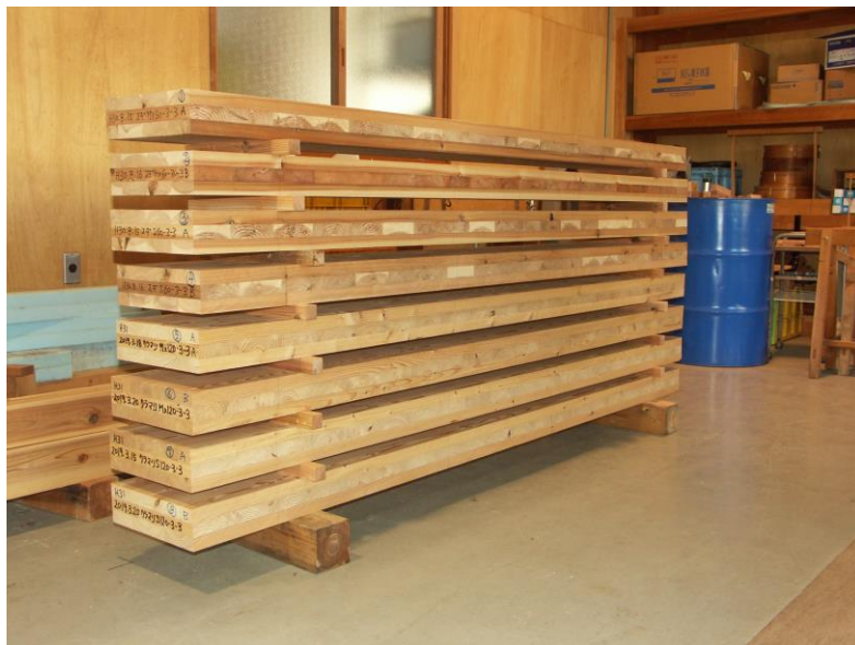
写真 1 製造したスギ CLT (上から 4 体) 及びカラマツ CLT (下から 4 体)
