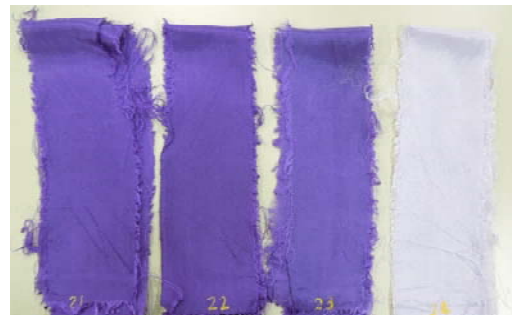
図3 直接染料を用い硬度の異なる水でレーヨンの生地を染色したときの染色結果
