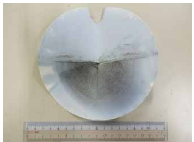
図8 酸性染料の溶け残り（硬度約 1300mg/L のドイツのミネラルウォーターを用いた場合）
