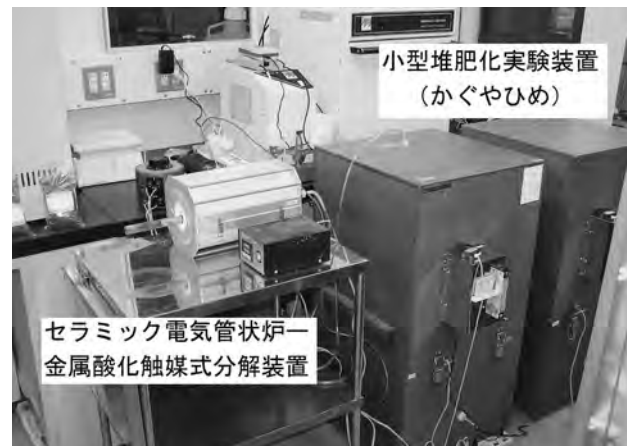
写真-11 セラミック電気管状炉-金属酸化触媒式分解装置
