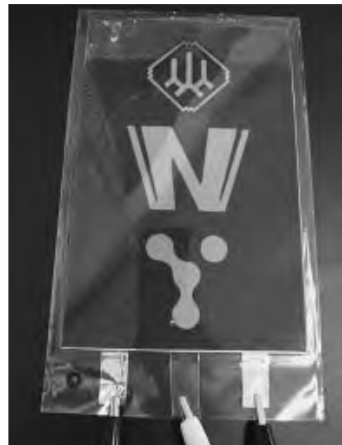
図8 試作したPEN基板上膜を使用した表示装置
