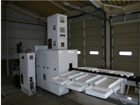
第 1 図 透過型光センサー「FQA-21」の外観
