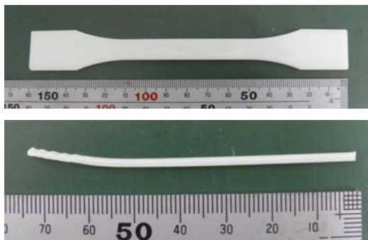
図1 3点曲げ試験に用いた試験片（上：材料試験片， 下：メルトインデクサ排出の棒状樹脂）
