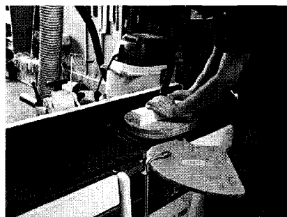
Fig. 45 手押し鉋盤の円盤研磨作業風景
