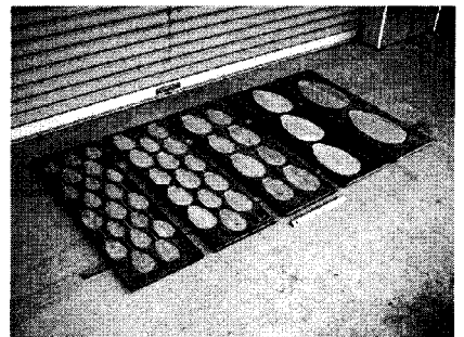
Fig. 66 ワイドベルトサンダー用円盤研磨治具
