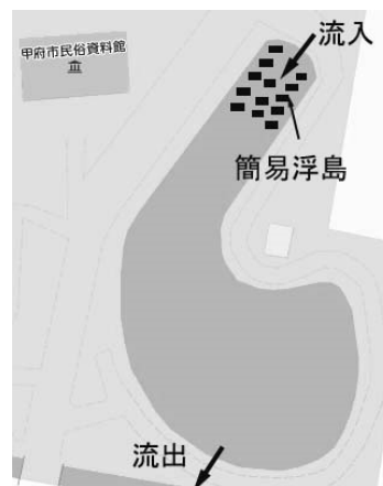
図 1 簡易浮島配置図
